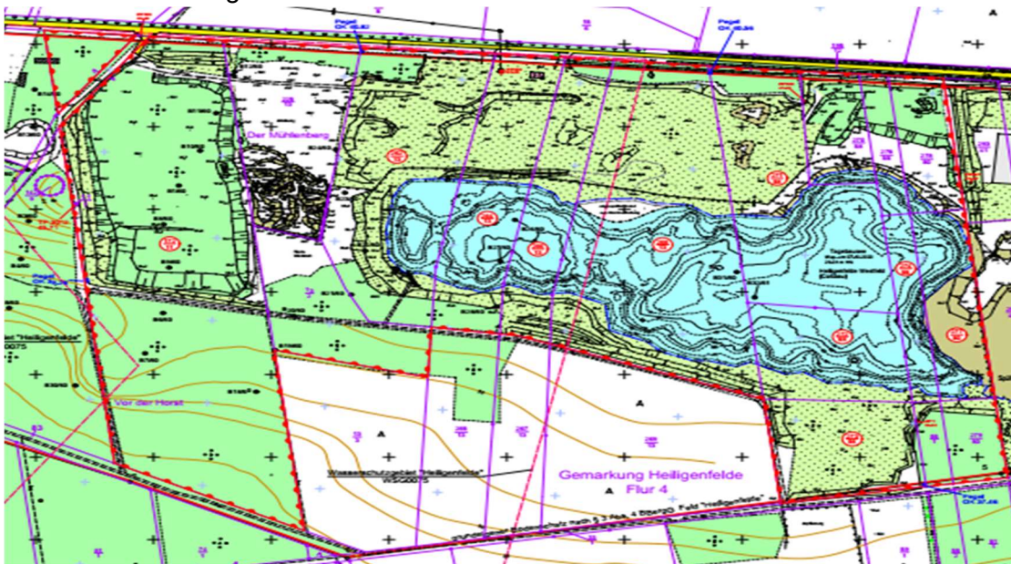
Abschlussriss mit Abschlussbetriebsgrenze (Westbereich)
